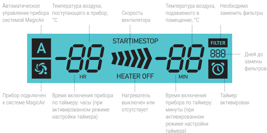
Рисунок 3. Все элементы ЖК-дисплея
