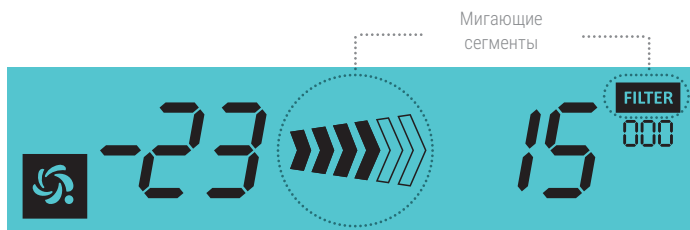
Рисунок 17. Настройка уведомления о замене фильтров
